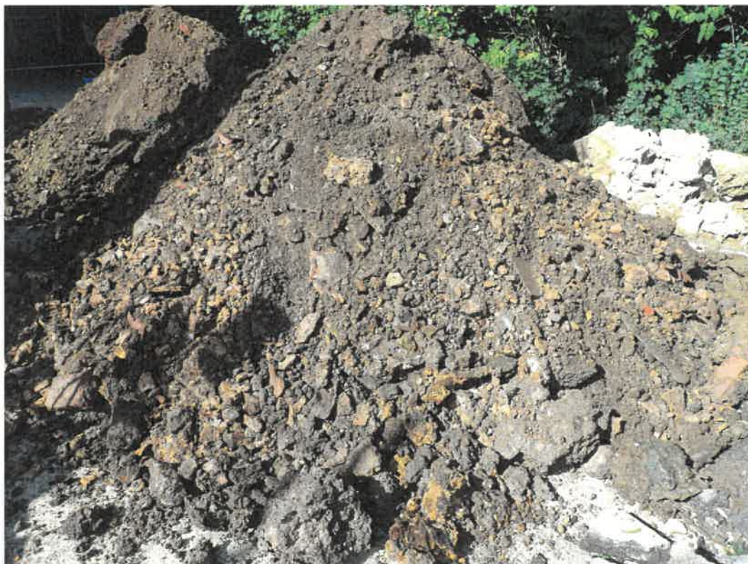
Foto 4: Angefallener Aushub der Schürfgrube SG 1-2 (Probe: Geislingen SG 1-2)
