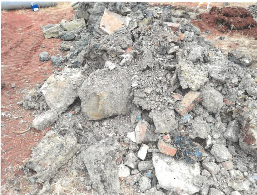
Foto 22: Angefallener Aushub der Schürfgrube SG 6-2 (Probe: Geislingen SG 6-2)
