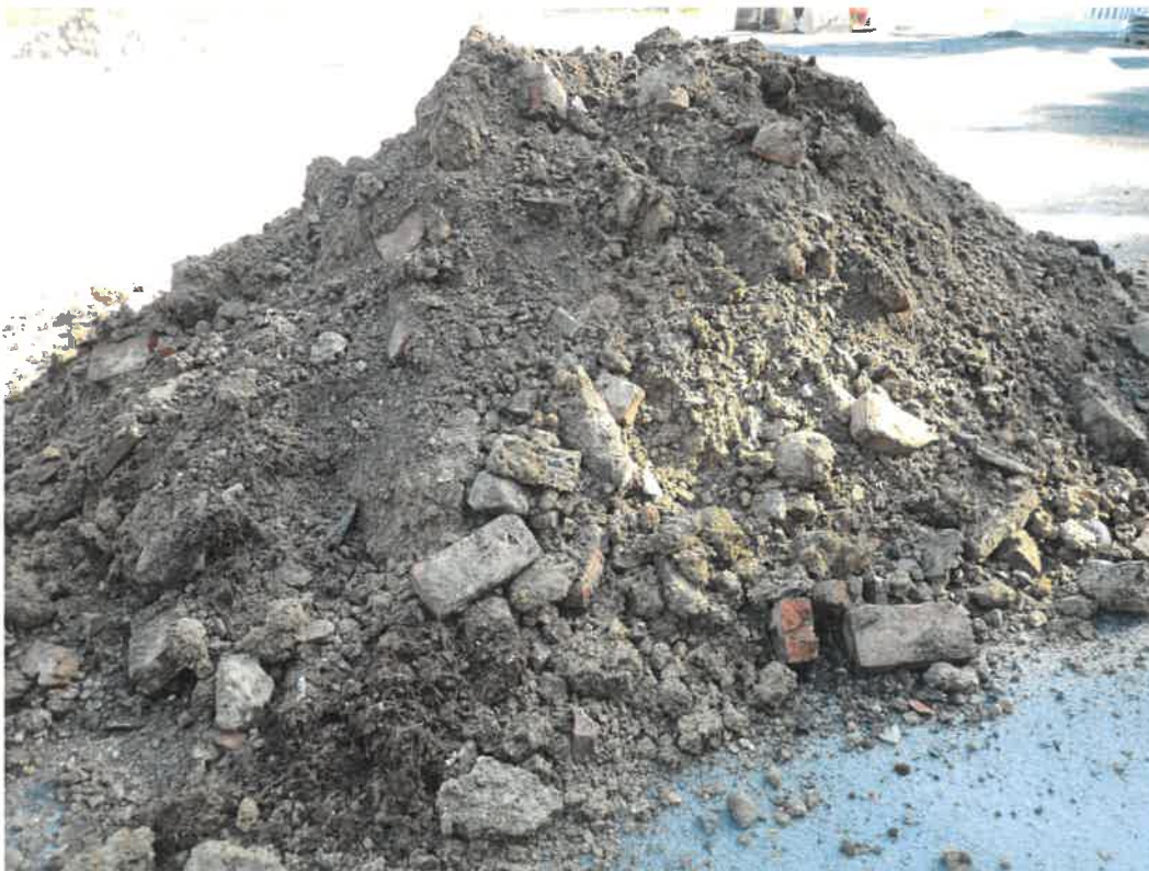
Foto 12: Angefallener Aushub der Schürfgrube SG 4-1 (Probe: Geislingen SG 4-1)
