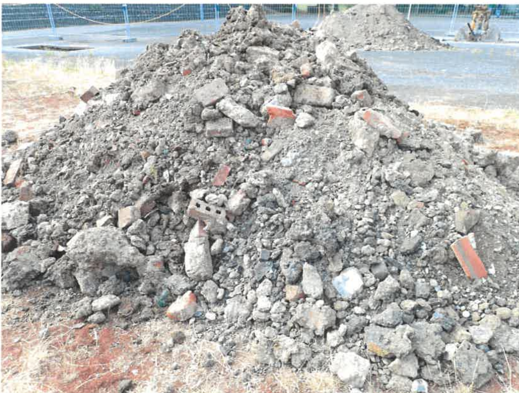
Foto 20: Angefallener Aushub der Schürfgrube SG 6-1 (Probe: Geislingen SG 6-1)
