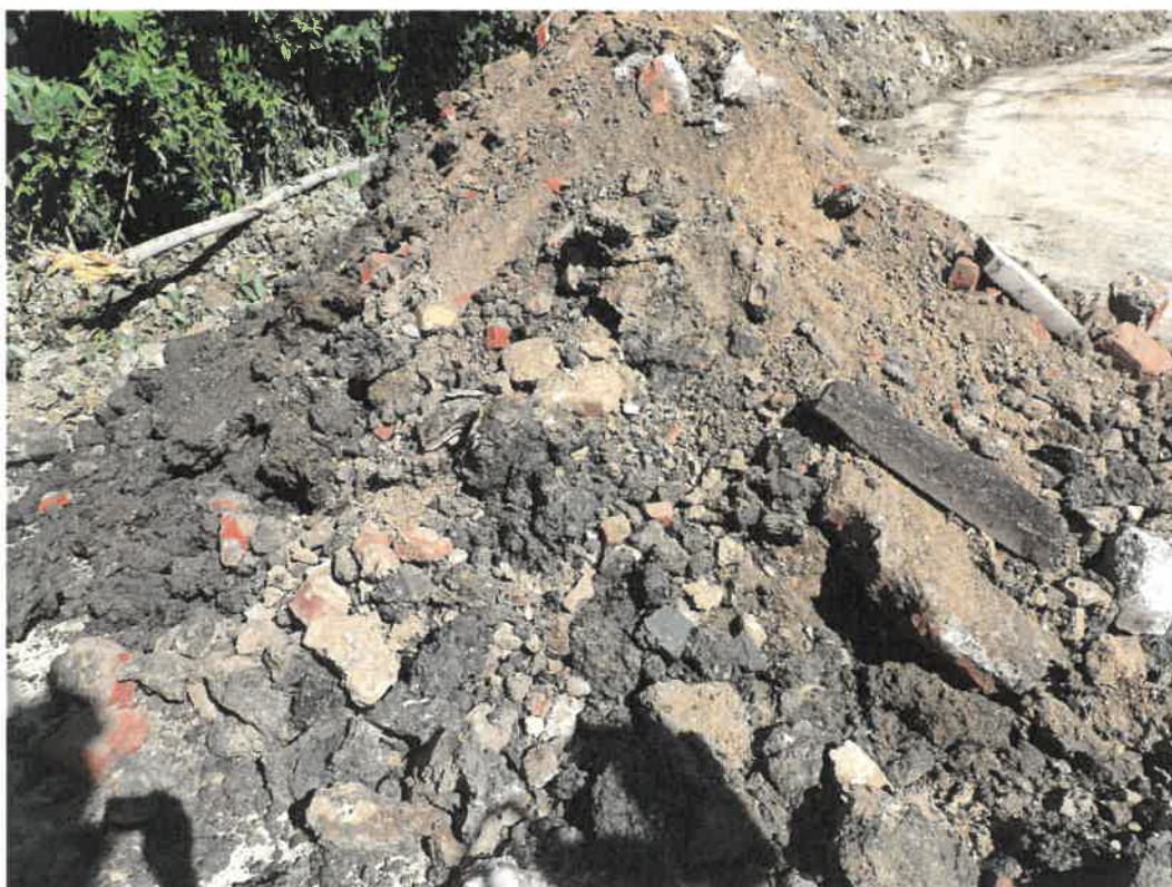
Foto 6: Angefallener Aushub der Schürfgrube SG 2-1 (Probe: Geislingen SG 2-1)
