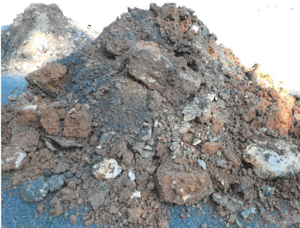
Foto 14: Angefallener Aushub der Schürfgrube SG 4-2 (Probe: Geislingen SG 4-2)
