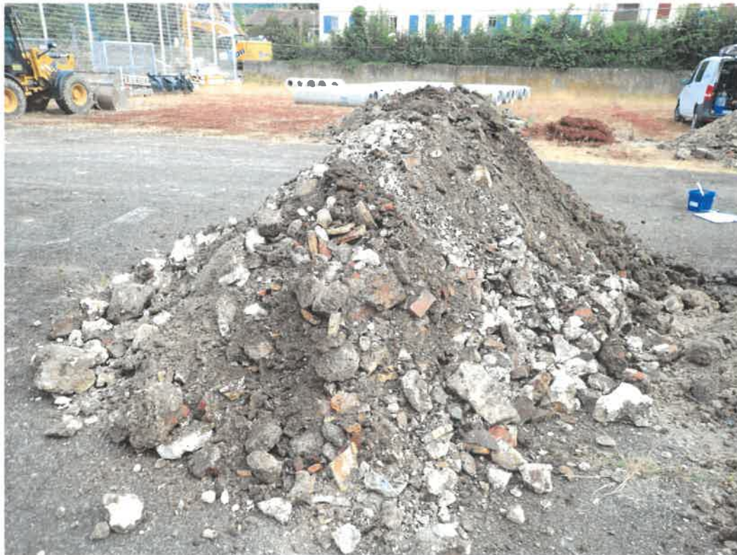
Foto 18: Angefallener Aushub der Schürfgrube SG 5-2 (Probe: Geislingen SG 5-2)
